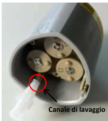
Figura 18: Canale di lavaggio
