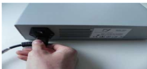
Figura 13: collegamento alla rete 220V
